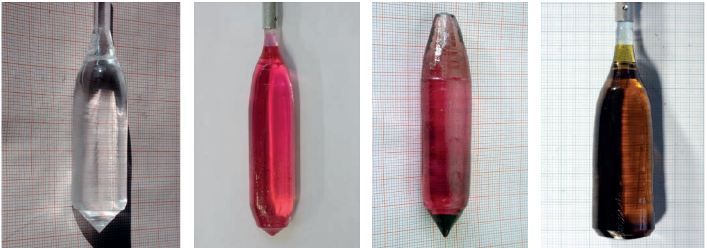
Abb. 1: Saphirkristalle mit unterschiedlichen Dotanden (v.l.n.r.: reiner Saphir, Cr-Saphir, Ti-Saphir, Ni-Saphir)
